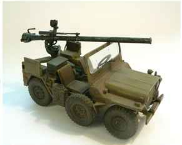
M151A2, Ford Mutt, Vehículo antitanque con cañon sin retroceso de 106mm
